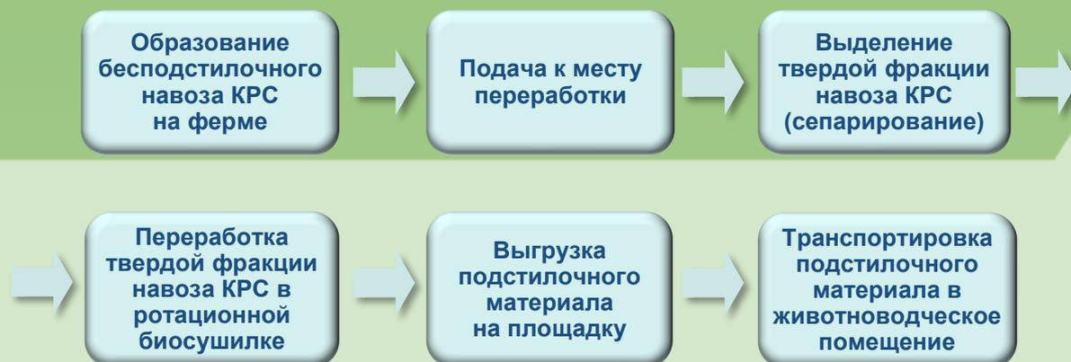
**Рисунок 1 – Технологическая схема приготовления подстилочного материала на основе навоза КРС**
